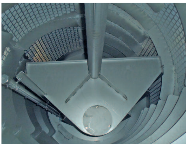
Фильтрующий барабан HUBER RoMesh® для оптимальной очистки от очень мелких загрязнений
