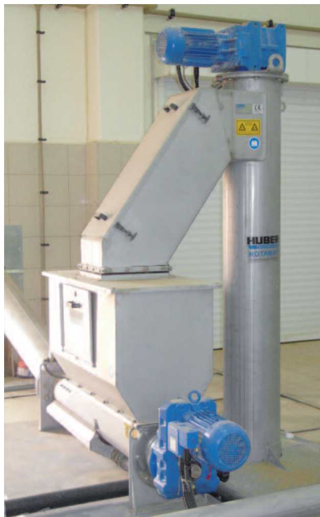
Вертикальная установка шнекового транспортера с отводом отбросов в моечный пресс HUBER
