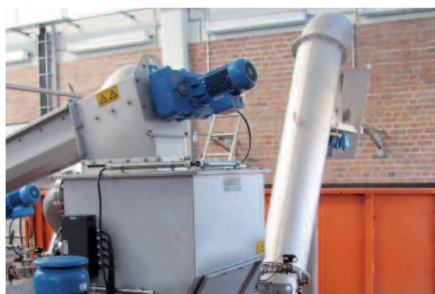
Шнековый транспортер HUBER ROTAMAT® Ro 8t с отводом отбросов в моечный пресс HUBER WAP/SL
